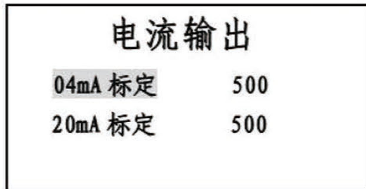
该功能在用户选择使用控制器电流信号 4~20mA 作为后级输出时，用于标定输出电流值的精确度，使用该功能时，在电流输出端接一高精度（0.1%级）电流表，如进行 4mA 标定，通过观察电流表测量示值与 4mA 的偏差计算出需要调整的数值，电流输出调整步进为 0.001mA，如电流表示值为 3.990mA，则在原有系数 500 的基础上增加 10，将修正系数 500 修改为 510 即可，输入完成后再观察电流表示值，如仍有误差继续按上述方法调整，直至电流表正好指示 4mA ( $\pm 0.004\text{mA}$ )。
