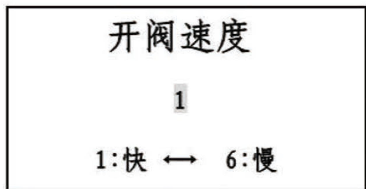
开阀速度可由用户调节，分 1、2、3、4、5、6 六个档位，按确认键进行修改，1 档为软件自动根据用户设置的瞬时流量自动调整开阀速度，2→6 档开阀速度越来越慢，即每次阀动作的间隔变大。阀的控制精度和开阀速度相关，开阀速度越慢，不容易出现超调现象，阀的控制精度越高，但调节时间变长。请用户根据实际控制需要选择，建议采用默认值 1，当 1 档不能满足现场要求时，再选择其他档位。
