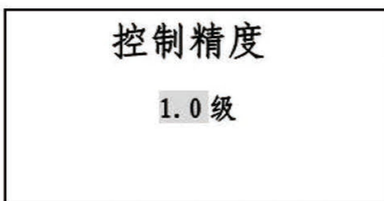
控制精度可根据需要调节，共有 1.0 级、1.5 级、2.0 级、2.5 级四个等级，如设置为 1.0 级时，控制器流量控制误差在±1% 范围内，用户可根据实际控制需要进行选择。
