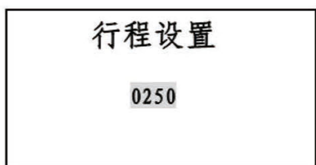
行程设置需要输入密码才能进入，正常使用过程中用户不需要设置。行程表示阀门从关闭到全开电机转动的总圈数，用于阀门当前位置计算，用户使用过程中不需要设置。
