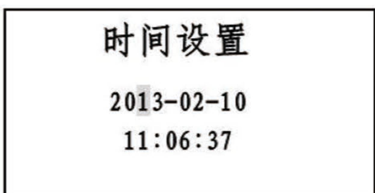
该功能设置控制器实时时间，设置时用户可通过左右键选择修改位，上下按键进行修改该位数据的大小，长按上下键可实现快速调整，并在选择后利用菜单/确认按键保存退出，或按下返回/取消按键不改变退出，修改后的时间将更新主显示界面上的时间显示。
